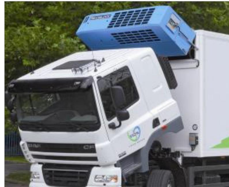
Abb.: LKW mit Transportkältemaschine
