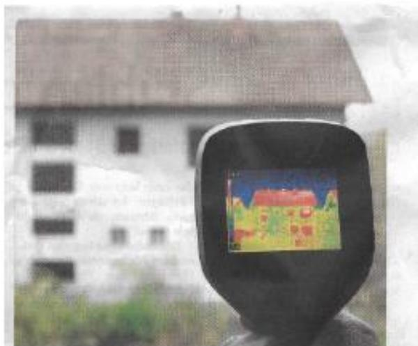
Kältebrücken auf der Spur: Die Wärmebildkamera zeigt auf, wo das Haus Wärme, also Energie verliert. Foto: KVHS
